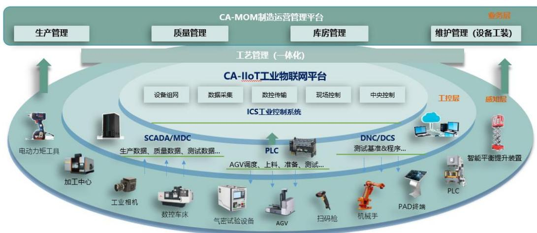
图8 设备物联及工业控制结构图
