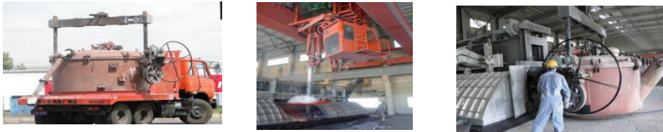
图 1-3 铝电解生产操作（换极-出铝-运铝）
