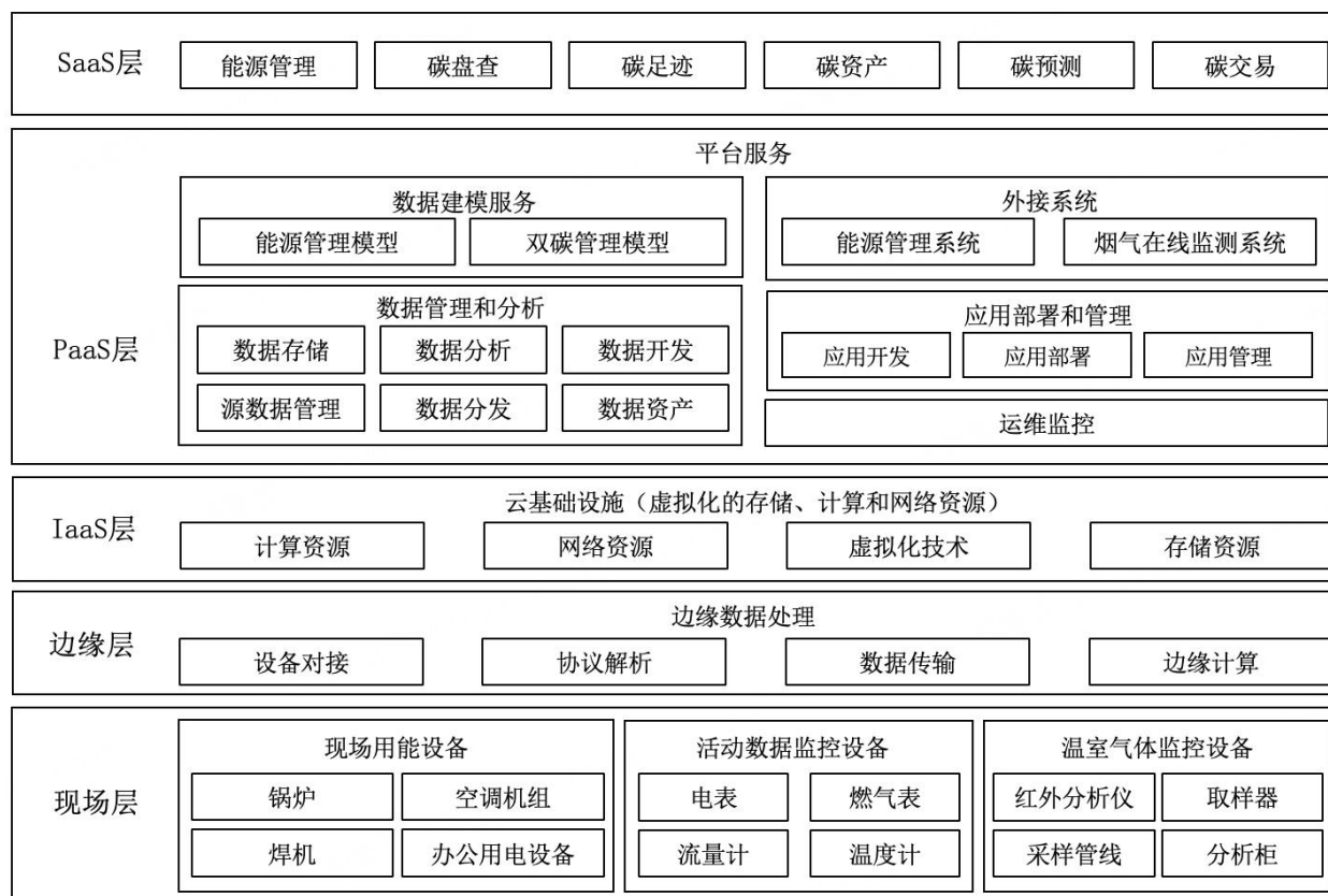
图1 汽车整车制造企业温室气体数据管理平台总体参考架构
